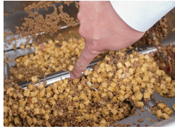
生ごみ処理機「SINKPIA」の生ごみ分解の様子。生ごみが、進んだ状態で微生物が分解され、堆肥になります。
